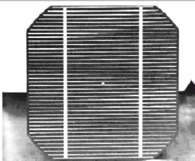
*Fig. 1.2 (c): Solar Cell: Actual view*
